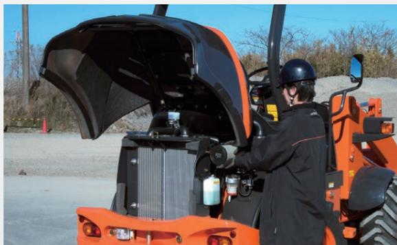
車両故障を予防するには点検やメンテナンスが最も重要です。ミニZW-5Bシリーズは大型ボンネットの採用で、メンテナンスポイントに簡単アクセス。愛機を大事に、末永く使っていただくために考えられたレイアウトです。
