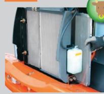
大きなゴミによる目詰まりを防止するためのスクリーンです。スクリーンは容易に脱着でき、キャッチしたゴミを簡単に取り除くことができます。
