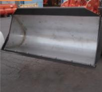
耐食性に優れたステンレス鋼をバケットの内側に張り付けたバケットです。粘着性の高い扱い物の荷離れ効果も期待できます。
