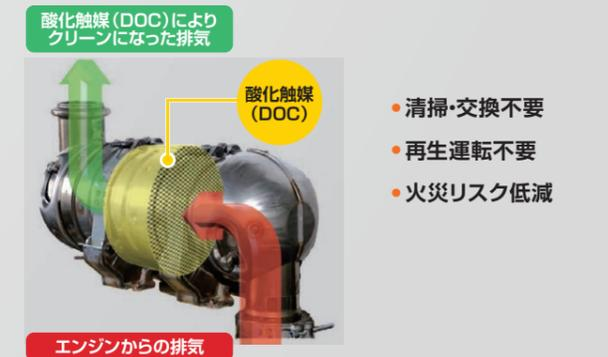
マフラフィルタ不要で特定特殊自動車排出ガス2014年基準をクリアする新型エンジンを搭載しています。そのためマフラフィルタに伴う清掃・交換がなく、再生運転を気にする必要のない車両です。このため、排気温度が比較的低く、火災がおきるリスクを低減しています。
