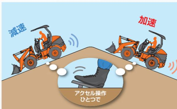
加速・減速はアクセルペダルの操作だけ。HST(Hydro Static Transmission)の効果で面倒なギヤチェンジがありません。
