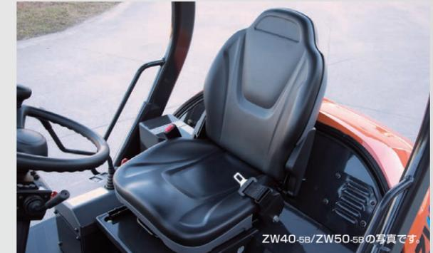
凸凹な路面を走行するオフロードでは車体が不意に傾くことで、運転者が転落する恐れもあります。ミニZW-5Bシリーズは、運転者を万が一の事故から守るシートベルトを標準装備。ZW40-5B / ZW50-5Bには自動車に近いフィーリングで使える巻取式シートベルトを標準装備。
