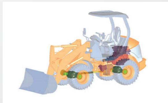
車両の心臓部である駆動系には、旧型機で耐久性を実証されたパーツを厳選して使用。作業機ジョイント部には潤滑性に優れたHNブッシュを採用しています。親しみのあるデザインの中に重機に必要な耐久性を備えています。
