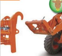
アタッチメントの交換を容易にする装置です。手動式と油圧式から選択できます。
