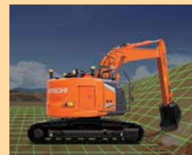
位置情報により掘削面を認識。
