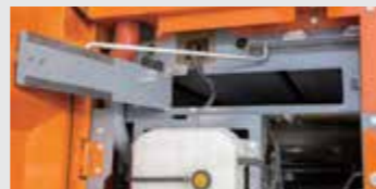
開閉可能なラジエータ清掃窓
