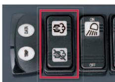
DPF手動再生 / 再生禁止 選択スイッチ [標準]
