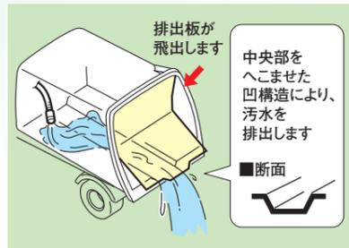
排出板がボデー後端より飛出して停止するため、ボデーの底に残ったごみを楽に洗浄できます。
