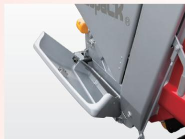
テールゲートのサイドカバーに開閉式ポケットを装備。開閉式なので、走行時の内容物の脱落を防止します。
