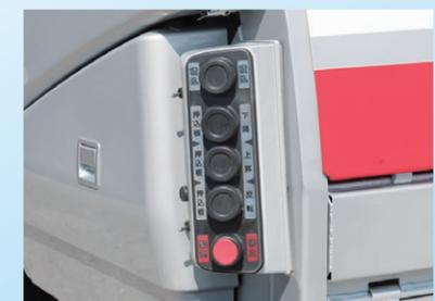
投入口横のローディングスイッチの操作盤を左斜め後ろ向きに設置。車両側方からの操作が可能となり、ホッパ内で収集物が暴れても安全に作業が行えます。
