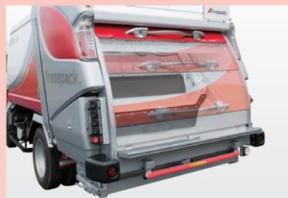
一体型ワンタッチハンドルを採用し、スライド機構を最適化したインナーライドカバーを標準装備。よりスムーズな開閉操作を実現し、作業負担を軽減します。
