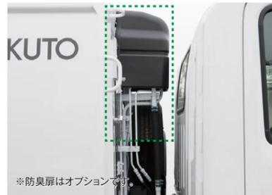
油圧回路を見直すことで、従来機に比べ積込作業時の作動音を低減し、住宅地での早朝の収集など、周辺環境への配慮が必要な作業に貢献します。
