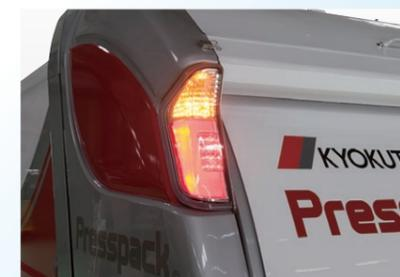
テールランプに専用設計のLEDリヤコンビネーションランプを採用。車両後方および側方からの視認性が向上し、より安全な収集作業に貢献します。
