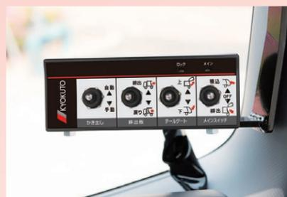
キャブ内操作スイッチの形状を変更し、スイッチランプにはLEDを採用することで、操作性および視認性を向上させています。
