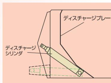
シリンダの取付角度およびブラケットの構造を変更し、ボデーを前側に搭載することで、車両の取回しを向上させます。
