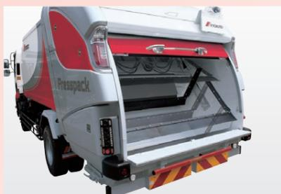
プレスプレートの形状を変更し、ごみの圧縮率を向上させることで、よりスムーズで高効率な積み込みを実現しました。
