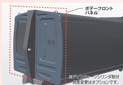
ボデー断面やフロントパネル形状などボデー構造の最適化により、ボデー容積と剛性を向上。作業効率の向上に貢献します。
