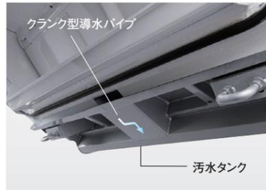
テールゲートにクランク型導水パイプを採用し、走行時の汚水の噴出を防ぎます。
