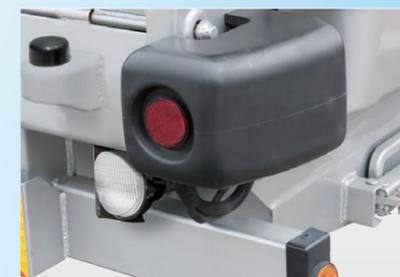
車両左右後端に反射器付きの大型コーナーガードを標準装備し、安全の確保と万一の車両の傷付きを防止します。
