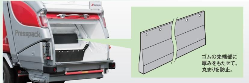
テールゲート内部の飛散防止ゴムの先端部に厚みをもたせた“丸まり防止形状”を採用し、汚水の飛散やにおいを低減しています。
