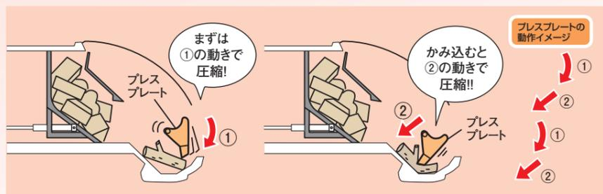
通常、①の動きでごみを積んでいます。プレスプレートが硬いものをかみ込むと、圧縮の方向が自動的に②に変わり、パワーアップ。ごみを効率よく圧縮変形します。その後①⇔②をくり返しながら、ごみを効率よく積み込みます。
