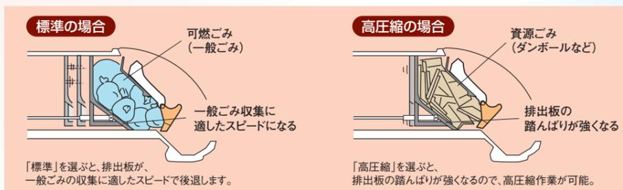
排出板自動後退スピードを切換えるスイッチを標準装備。ごみの種類や作業状況に応じ、「標準」「高圧縮」の速さが選べます。
