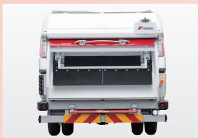
クラス最大級の投入口幅を確保(2t:1,440mm、3.5t:1,685mm、4t:1,700mm)し、ワイドな投入口幅でより効率的な作業を可能としました。
