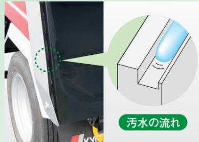
ボデー後端スチフナには、汚水の漏れと噴出を防止するスチフナ形状を採用しています。
