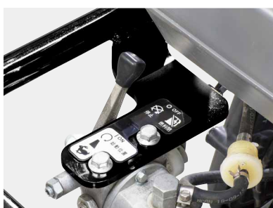
ワンスロットルレバー (エンジンと燃料を同時ストップ)
